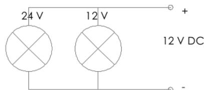
12V/24V DC ~400mA, (24V/36V DC ~200mA – auf Anfrage) redundant, Beleuchtungsstärke: 5W, Schutzart: IP 54, im Lieferumfang enthalten ca. 3m Steuerleitung LiYY 2 x 0,25m<sup>2</sup> (braun +, weiß -)
